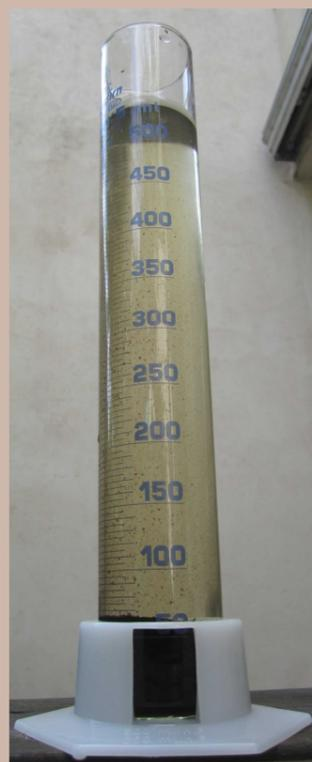
Mesure du temps de décantation des vases
