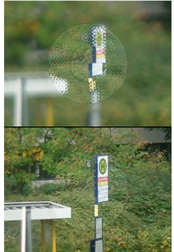
Le fonctionnement d'un stigmomètre (illustration wikipédia)
